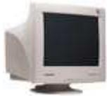
Retour quelques années en arrière, avec les écrans dits *CRT* (à tubes cathodiques) et nos épais téléviseurs. A cette époque ce sont des tubes cathodiques à l'intérieur de l'écran qui permettent de créer un affichage, d'où l'épaisseur de nos moniteurs. Aujourd'hui les technologies sont complètement différentes avec les dalles *LCD* qui permettent d'obtenir des écrans de seulement quelques centimètres d'épaisseur.
